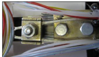
**Примечание** – Если ЦСЭ представляет собой стальной трос с полимерным покрытием, выполнить электрическое соединение ЦСЭ с броней ОК, используя перемычку электрического соединения.
