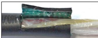
**5.2** Извлечь ОК из оголовника и с учетом намеченного положения установки соединителя сделать на полиэтиленовой оболочке совместно со стальной гофрированной (алюминиевой) лентой продольный разрез на длине 25 мм от ее торца, а затем – круговой на 1/2 длины окружности. Отогнуть участок оболочки вместе с лентой. Обезжирить и зачистить внутреннюю поверхность ленты под этим участком оболочки ОК.
