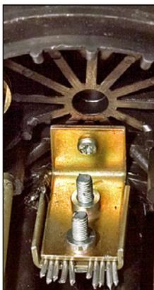
**Примечание** – Если ЦСЭ представляет собой стальной трос с полимерным покрытием, выполнить электрическое соединение ЦСЭ с броней ОК, используя перемычку электрического соединения.
