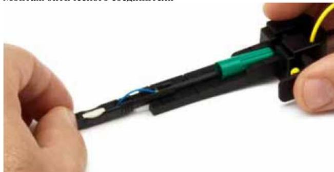
Следует применять держатель для обеспечения автоматической ориентации торца оптического волокна и для осуществления ввода оптического волокна в канал оптического соединителя. После того, как получившийся изгиб оптического волокна индицирует о том, что волокно введено на всю глубину, нажатием на кнопку следует активировать сборку оптического соединителя.
