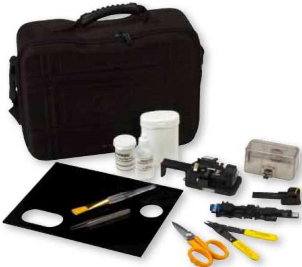
Комплект 8865-AS производства компании 3M (3M™ No Polish Connector Angle Splice Kit 8865-AS) содержит угловой скалыватель 2535 производства компании 3M (3M™ Fiber Optic Angle Cleaver 2535) и весь инструмент, необходимый для монтажа оптических соединителей 8802-T/APC/AS/1.6-3 на оптическом кабеле и для монтажа оптических соединителей 8800-APC/AS на оптическом волокне с диаметром покрытия 250 мкм и 900 мкм.
