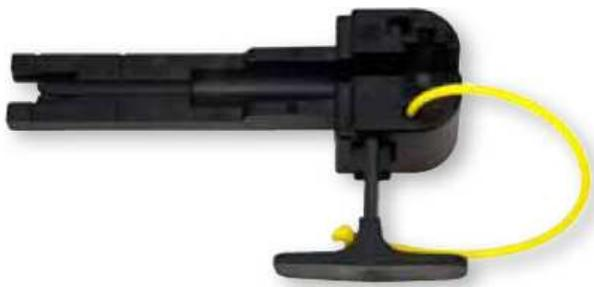
Инструмент 8865-JT производства компании 3М для монтажа соединителей оптических волокон типа “No Polish SC/APC Connector (NPC) Jacket” входит в каждый комплект из 60 шт. соединителей с угловым стыком торцов оптических волокон. Инструмент при монтаже соединителя на кабеле обеспечивает необходимое расположение друг относительно друга соединяемых оптических волокон, торцы которых имеют угловой скол.
