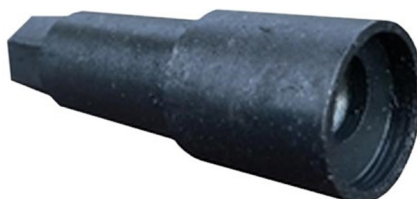
Рис. 8. Внешний вид ключа для ДКЛ.
