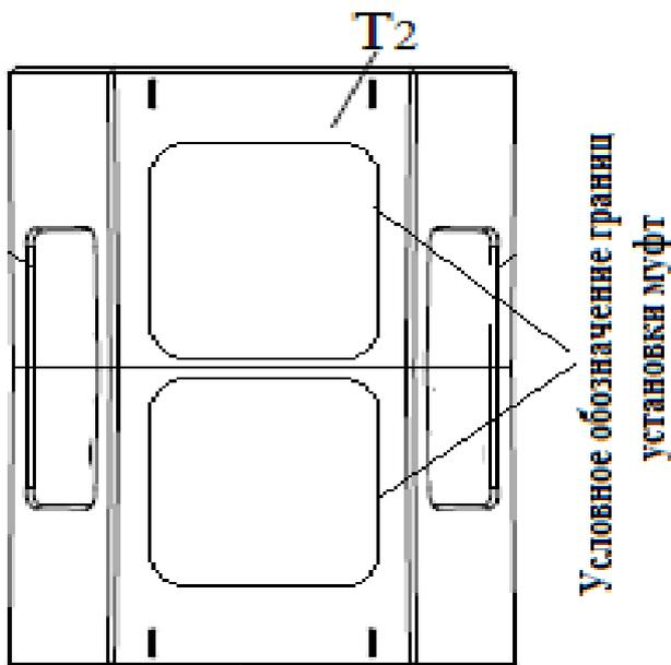
Примечание: на схемах указать места установки муфт в выбранные стенки колодца, их диаметр и количество в ряду верхнего и/или нижнего элементов колодца.
