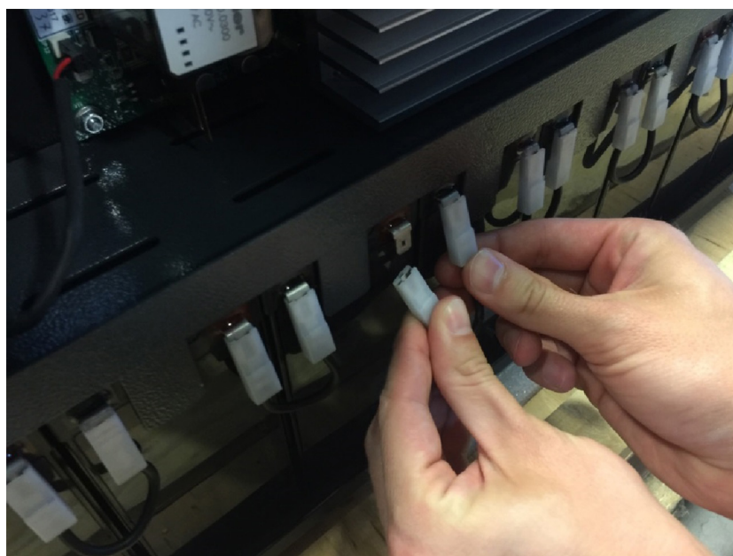
Рисунок 6 – Электрическое соединение батарей с помощью перемычки
