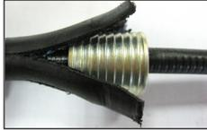
8.2 Установить втулку с наружной резьбой поверх лепестков сталеполиэтиленовой оболочки, надвинуть на нее штуцер
