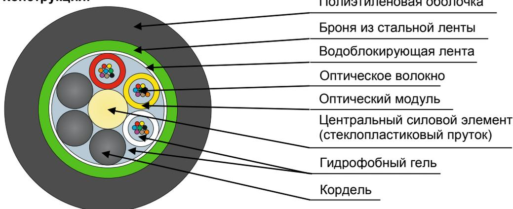
Кабель содержит сердечник модульной конструкции с центральным силовым элементом из диэлектрического стержня, вокруг которого скручены оптические модули со свободно уложенными волокнами. Свободное пространство в оптических модулях и в сердечнике кабеля заполнено гидрофобным гелем. На сердечник продольно накладывается водоблокирующая лента. Поверх водоблокирующей ленты накладывается броня из гофрированной стальной ленты и оболочка из полиэтилена средней плотности.
