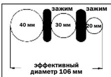
Замок ТУМ располагать со стороны кабеля, имеющего максимальный диаметр.
