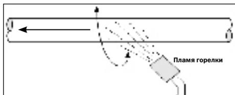
6. После усадки ТУТ (ТУМ) дополнительно прогреть ее по всей поверхности. Запорную шину ТУМ прижать к поверхности ручкой молотка или иного инструмента.
