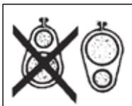
4. В случае применения ТУТ (ТУМ) для герметизации кабеля с патрубком оголовника муфты усадку следует начинать с конца ТУТ (ТУМ), надвинутого на патрубок.
