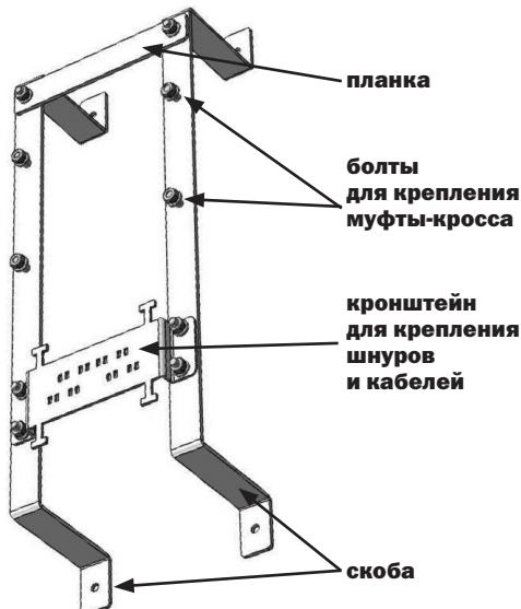
**3.2** Перед закреплением кронштейна на стене или опоре необходимо смонтировать кронштейн, соединив скобы при помощи планки и кронштейна, используя гайки с шайбами.
