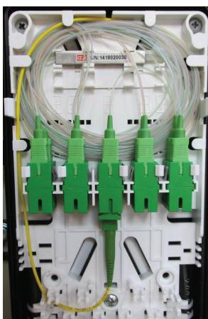
**1.11.6** Установить крышку вставки. Разместить вставку в корпусе муфты-кросса и закрепить вставку 3-мя крепёжными винтами.
