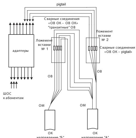
**1.2** На рисунке представлена схема подключения ОК и ОВ в муфте-кроссе (стык коннекторов оптических шнурков «пигтейл» с ШОС от оборудования потребителей/абонентов выполняется непосредственно).
