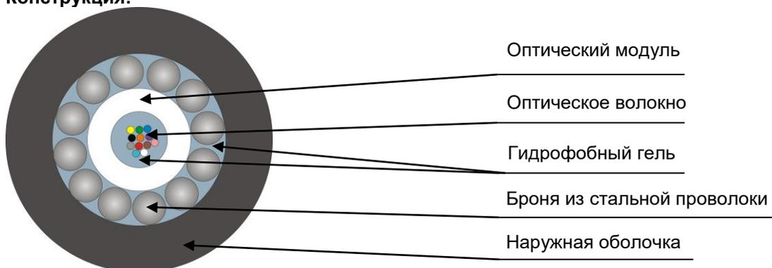
Кабель содержит центральный оптический модуль со свободно уложенными волокнами. Свободное пространство в оптическом модуле заполнено гидрофобным гелем. На центральный оптический модуль спирально накладывается броня из стальных проволок. Свободное пространство между проволоками заполнено гидрофобным гелем. На броню накладывается оболочка из полимерной композиции, не распространяющей горение при одиночной прокладке.
