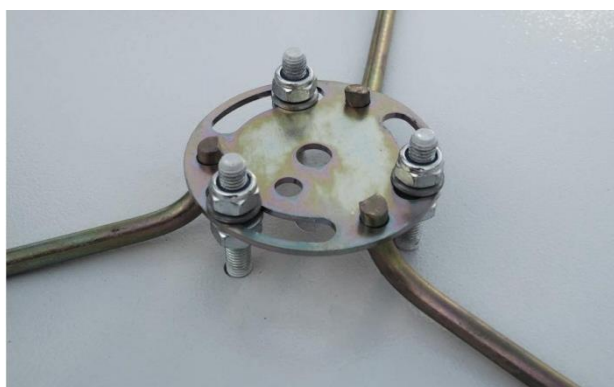
Рисунок 6. Поворотный механизм устройства типа «Краб». Вид с нижней стороны устройства.
