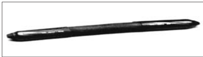
Рис. 4.42. Отрезок кабеля с термоусаживаемыми колпачками
