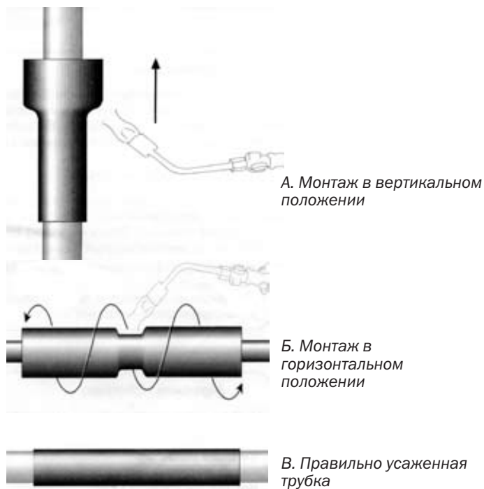
Рис. 4.1. Схема работы с термоусаживаемой трубкой
