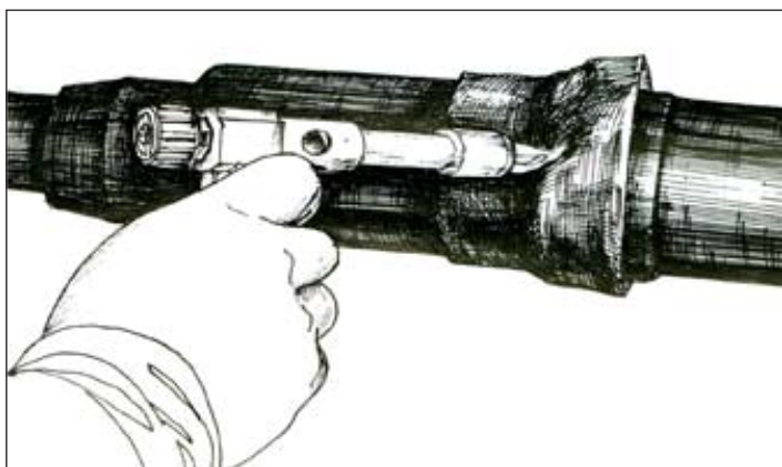
Рис. 4.2. Усадка термоусаживаемой трубки на среднем стыке
