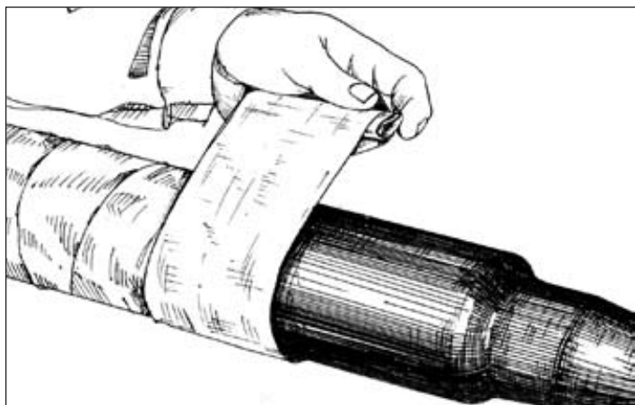
Рис. 4.35. Обмотка муфты кабельной бумагой
