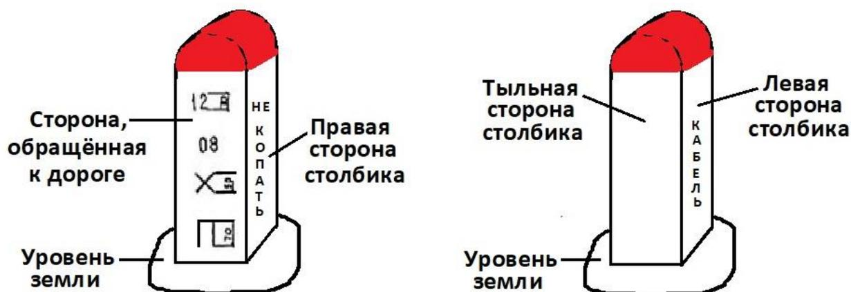
Рис. 6. Определение сторон столбика на трассе кабеля и примеры нанесения надписей на них.
