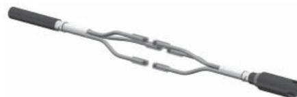
Надеть на жилы кабелей прозрачные трубки, сдвинуть их до упора в основание разделки. Последовательно усадить изолирующие трубки в направлении от корня разделки к концам кабеля. Повторить операции для второго конца кабеля.
