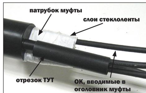
**– цилиндрической части корпуса муфты (для муфты типа МОГ – труба) и оголовника муфты.**
