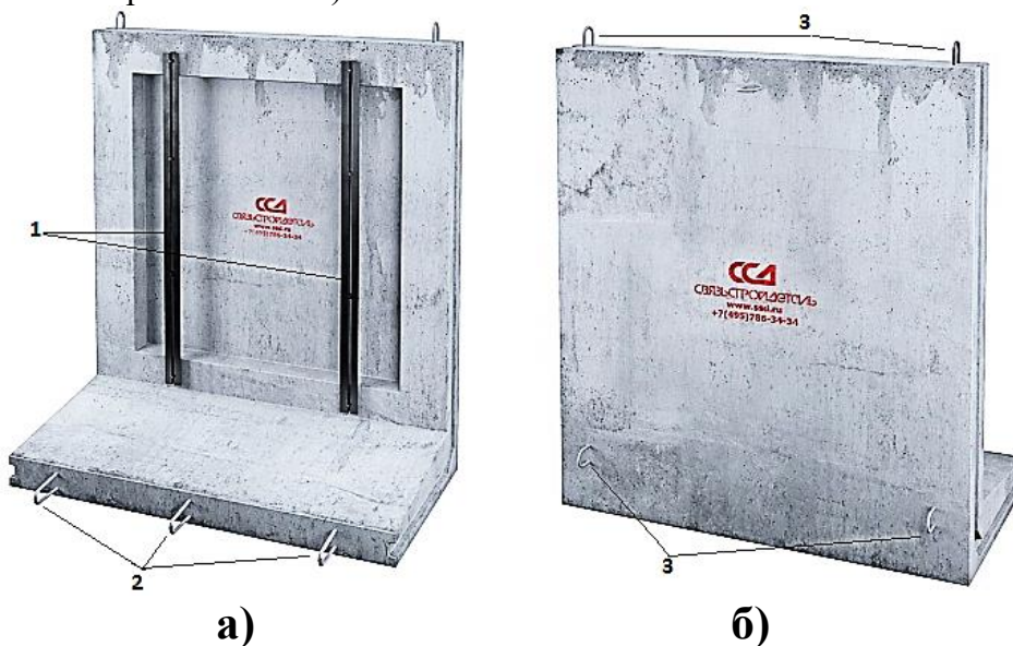
Рис. 64. Внешний вид и детали стенового блока «СБ-1 ГЕК»: а – вид с внутренней стороны блока; б – вид с наружной стороны блока; 1 – кронштейны ККУ-160 приваренные к выпускам арматуры; 2 – технологические выпуски арматуры для скрепления блоков; 3 – подъёмные (строповочные) петли.
