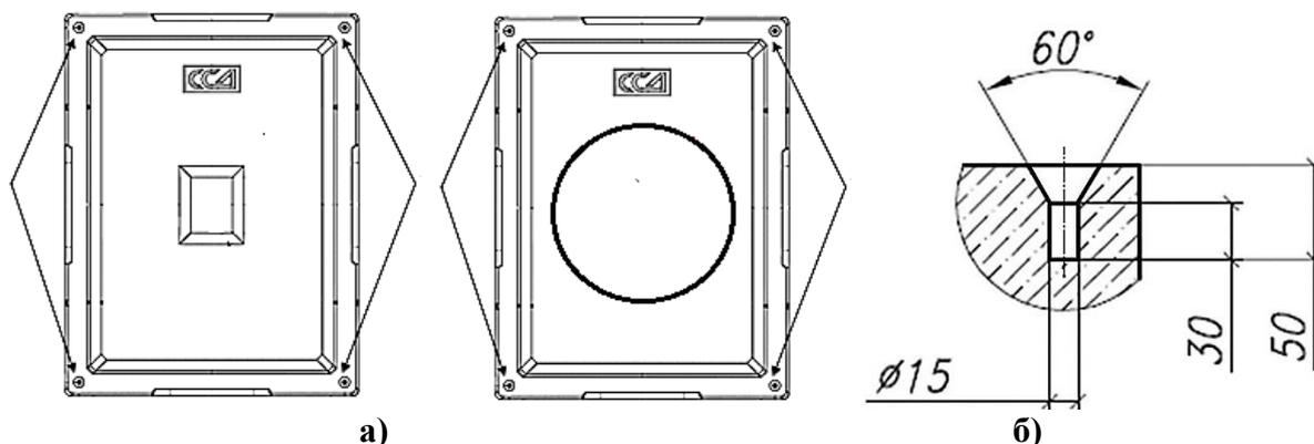
Рис. 11. Углубления для стержней на углах элемента колодца и форма углубления:
