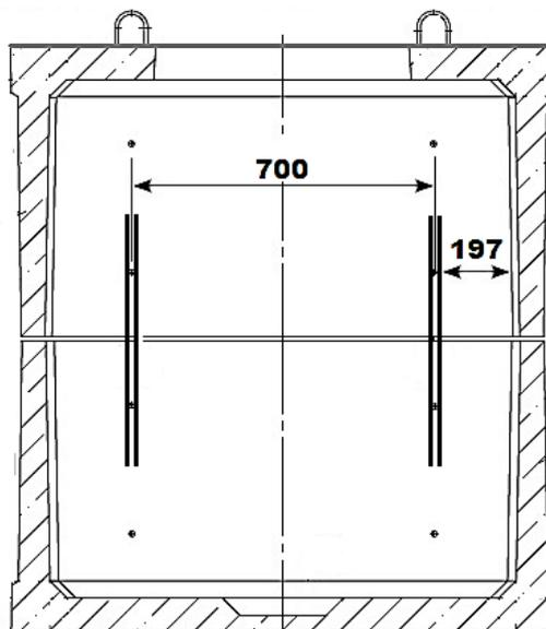
Рис. 1.1. Боковая стена колодца «ККСр-2М-10(80)» с установленными кронштейнами.
