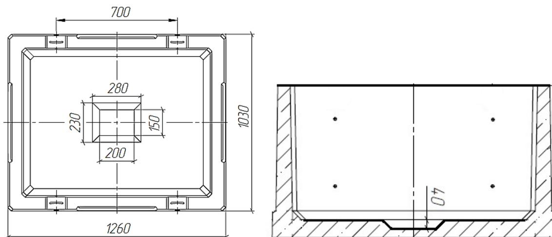
Рис. 9. Размеры приемка в нижнем элементе колодца ККСр-2М-10(80).
