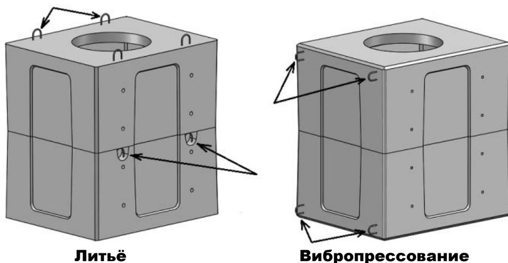
Рис. 3. Места выхода подъёмных петель на элементах колодцев.
