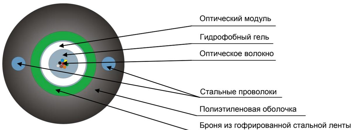
Кабель содержит оптический модуль со свободно уложенными волокнами. Свободное пространство в оптическом модуле заполнено гидрофобным гелем. Поверх модуля накладывается броня из гофрированной стальной ленты и оболочка из полиэтилена средней плотности. Свободное пространство под гофрированной лентой заполнено гидрофобным гелем. В оболочке кабеля диаметрально противоположно расположены две стальные проволоки, которые выполняют функции силовых элементов.
