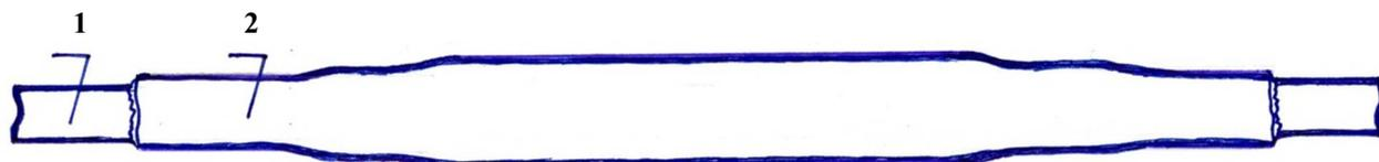
Рис. 12. Внешний вид смонтированной муфты после усадки наружной трубки ТУТ:
