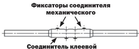
**2.2.4** Выполнить операции в соответствии с 2.2.3 для другого разделанного отрезка соединяемого стеклопластикового прутка.
