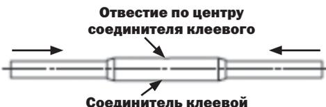
**2.1.6** Обеспечить неподвижность приклеиваемых поверхностей стеклопластикового прутка и соединителя клеевого в течение суток для достижения рабочей прочности клея ВК-9.
