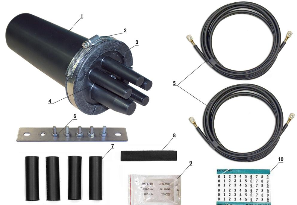
1 – корпус; 2 – хомут из нержавеющей стали; 3 – полухомут (2 шт.); 4 – оголовник; 5 – перемычка (провод ГПП 1x4 с герметизированной многопроволочной жилой сечением 4 мм<sup>2</sup>, длиной 2 м, оконцованный наконечниками кабельными КВТ4-6-3), 2 шт.; 6 – панель уравнивания потенциалов (с клеммами в виде болтов и гаек М6 из нержавеющей стали; 5 шт.); 7 – отрезок ТУТ 28/6 (4 шт.); 8 – отрезок шкурки шлифовально; 9 – силикагель; 10 – маркер
