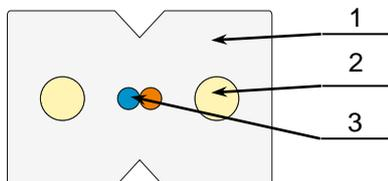
1. Оболочка из полимерной композиции, не распространяющей горение, с пониженным дымо- и газовыделением
