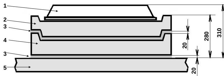
Рис. 14. Высота горловины с парой колец КО-ЧП и КО-Ч: 1 – люк чугунный лёгкого типа; 2 – кольцо «КО-Ч»; 3 – слой бетона; 4 – опорное кольцо «КО-ЧП»; 5 – перекрытие колодца «ККСр-4-10».
