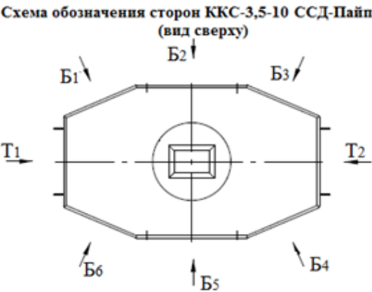
ТЗ на предустановку муфт в стенки колодца ККС-3,5-10 ССД-Пайп*
