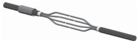
Снять с жил изоляцию на длине равной глубине отверстия в соединителях. Зачистить и обезжирить токоведущую часть жил.
