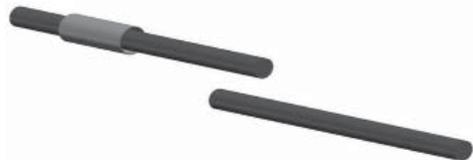
Удалить наружный покров с соединяемых концов кабеля, на длине 300 мм от опорной линии.
