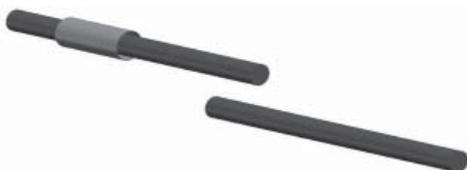
Удалить наружный покров с соединяемых концов кабелей, длиной 200 мм от опорной линии.
