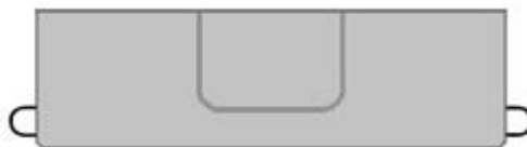
Рис. 9. Вид сбоку на корпус колодца «ККСр-0,5-10(80)». Показаны места выхода подъёмных петель.
