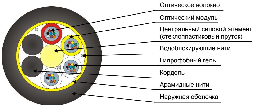
Кабель содержит сердечник модульной конструкции с центральным силовым элементом из диэлектрического стержня со спирально наложенной водоблокирующей нитью, вокруг которой скручены оптические модули со свободно уложенными волокнами. Свободное пространство в оптических модулях заполнено гидрофобным гелем. Сердечник скреплен обмоточными нитями с водоблокирующим свойством. На сердечник спирально накладываются арамидные нити и оболочка из полиэтилена средней плотности.
