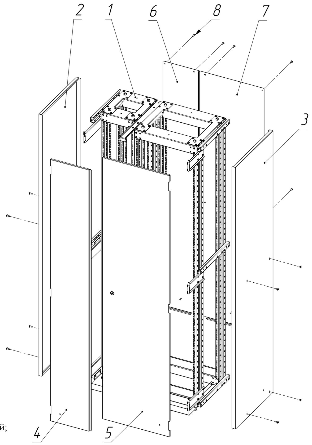
1. Дверь мал. поз.4 навесить на левые петли каркаса;
