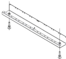
**3.** Установите кронштейны опорные (С) на собранные каркасы. Используйте винты М6 и гайки с насечкой М6.
