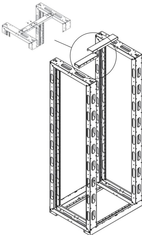
**Внимание!** Установите каркасы на глубину, необходимую для установки оборудования. Сориентируйте каркасы юнитовой маркировкой наружу стойки.
