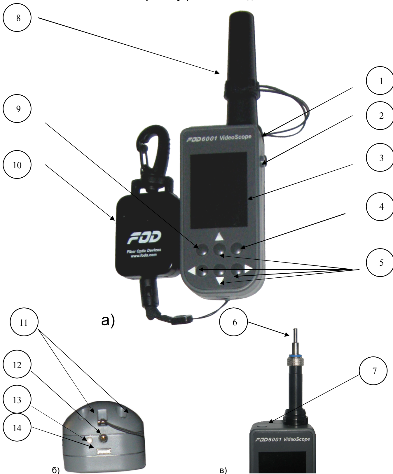
Рис. 6.1. Расположение органов управления
