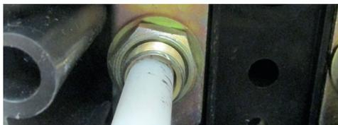
14. Распределить изолированные полиамидными трубками медные жилы каждого ОК на два пучка с одинаковым количеством проволок (4 шт. и 5шт). Завести под каждый зажим на обратной стороне cassette по одному пучку медных проволок каждого ОК, выходящих из полимерных трубок.
