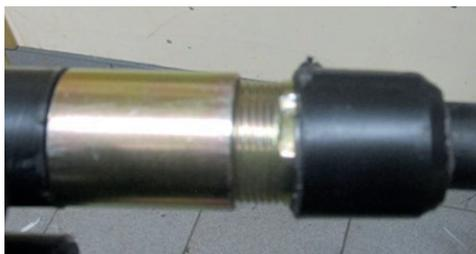
**19.** Прогреть пламенем газовой горелки пластмассовые поверхности на длине усадки трубки ТУТ 40/12 и усадить трубку.
