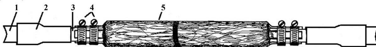
Рис. 8. Наложение фольги поверх алюминиевых пластин: 1 – полиэтиленовый шланг над оболочкой; 2 – трубка ТУТ продольной герметизации; 3 – алюминиевая оболочка; 4 – стальные винтовые хомуты; 5 – алюминиевая фольга, наложенная на полосы.
