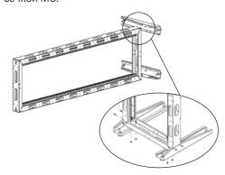
**4.** Осуществите организацию заземления Стойки с помощью комплекта заземления.
