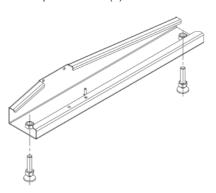
**3.** Установите кронштейны опорные (C,D) на каркас. Используйте винты M6 и гайки с насечкой M6.
