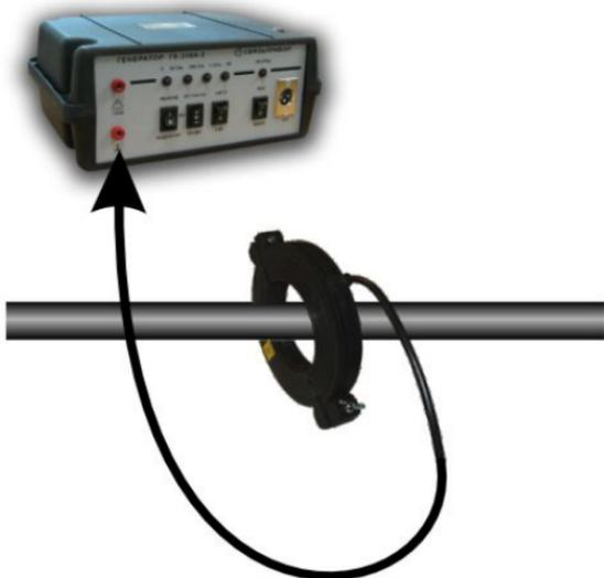
Застегните клещи-индуктор на тестируемом кабеле и подключите их к генератору ГК-310А-2, МК-510, (ГК-210А-2). Установите необходимый режим работы.
