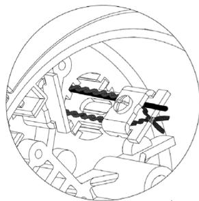
Скрепив концы каждого пучка арамидных нитей лентой виниловой (изоляционной) ЛВ1 ССД (далее – лента виниловая) на расстоянии 40 мм от узла крепления, обрезать излишки длин арамидных нитей.
