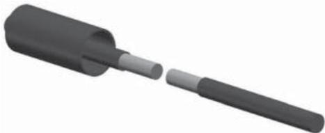
Удалить с концов жил изоляцию на длину равную глубине отверстия соединителя, очистить жилы от загрязнений, обезжирить.
