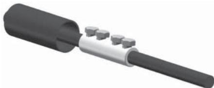
Произвести установку соединителя, все болты затянуть до срыва головок. Для удержания соединителя рекомендуется использовать специальный упор.
