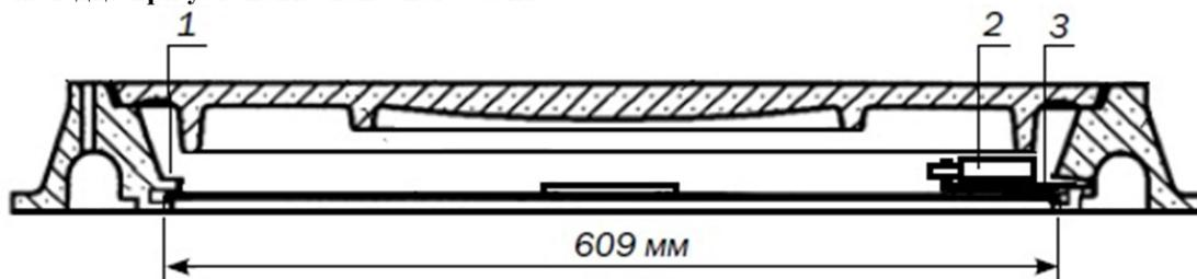
Рис. 2. Разрез люка с установленной крышкой и замком:
