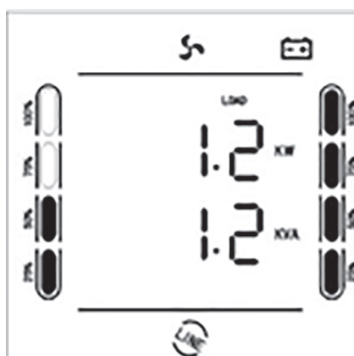
Figura 16. Visualizzazione del carico
