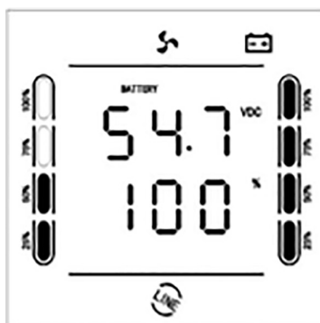
Figura 19. Visualizzazione della carica della batteria
