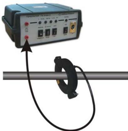
Генератор ГК-МИНИ также можно бесконтактно подключить к кабелю с помощью индукционных клещей\* (КИ-90). Клещи представляют собой индукционную катушку с разъемным магнитопроводом, который замыкается вокруг тестируемого кабеля. При таком подключении достигается более высокий уровень сигнала в линии и значительно снижается влияние на соседние магистрали.
