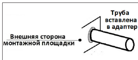
Рисунок 22 - Ввод гладкой трубы в адаптер
