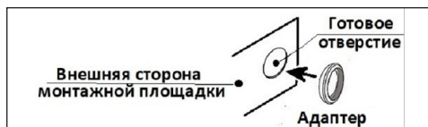
Рисунок 21 - Сверление отверстия в ККП-4-ССД для адаптера гладкой трубы
