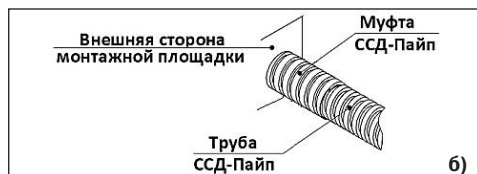
Рисунок 17 - Соединение трубы ССД-Пайп с адаптером ввода труб ССД-Пайп
