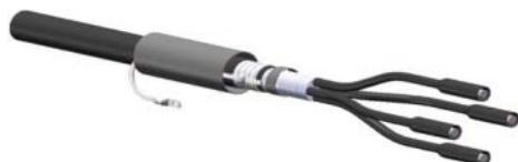
Закрепить провод заземления на наружном покрове бандажом из проволоки. Очистить и обезжирить оболочку, броню, наружный покров. Обмотать оболочку и бронеленты – герметиком узла заземления с заходом 20 мм на наружный покров кабеля.
