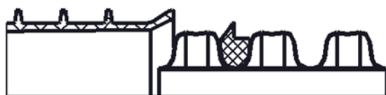
Рисунок 4 – Установка уплотнительного кольца в первую впадину между гофрами
