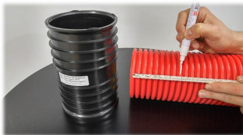
Фото 5 – Разметка трубы маркером
