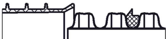
Рисунок 5 – Установка уплотнительного кольца во вторую впадину между гофрами
