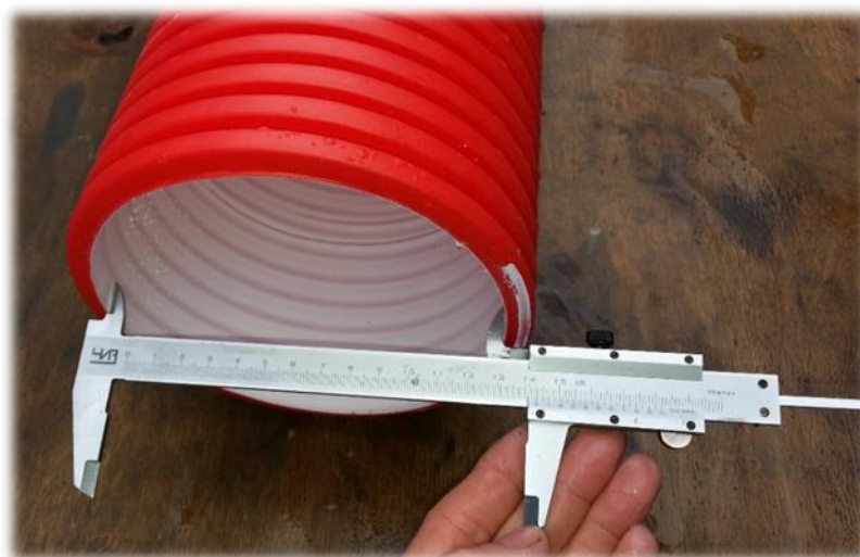
Фото 2 – Измерение внутреннего диаметра трубы
