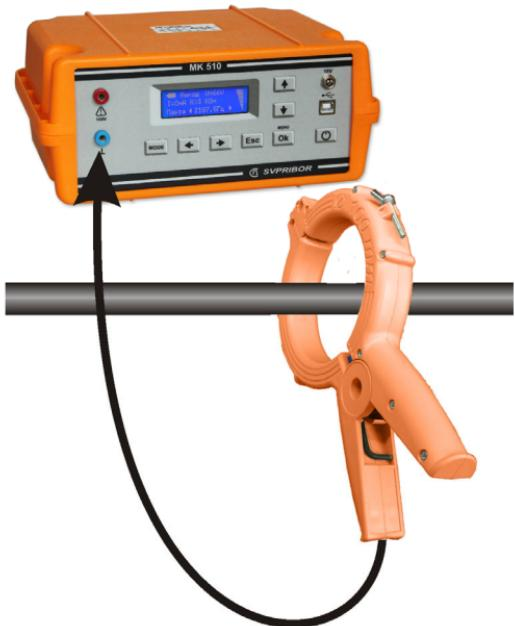
Застегните клещи-индуктор на тестируемом кабеле и подключите их к генератору МК310, МК-510, ГК-310А-2, ГК-210А-2, ГК-МИНИ. Установите необходимый режим работы.
