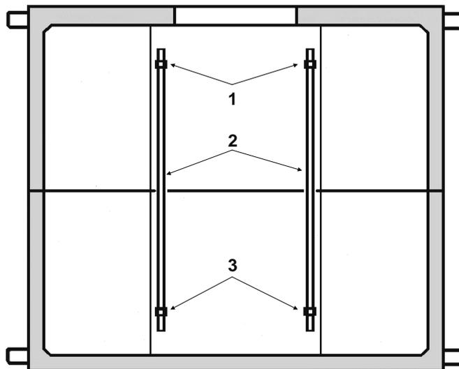
**Рис. 3.4. Боковая стена колодца «ККСр-3,5-10(80)» с установленными кронштейнами «ККП-130».**
