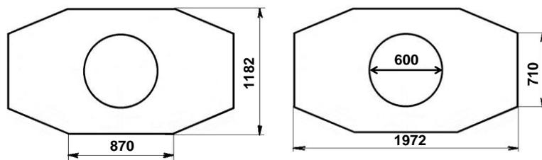
Рис. 4. Размеры перекрытия колодца «ККСр-3,5-10(80)».
