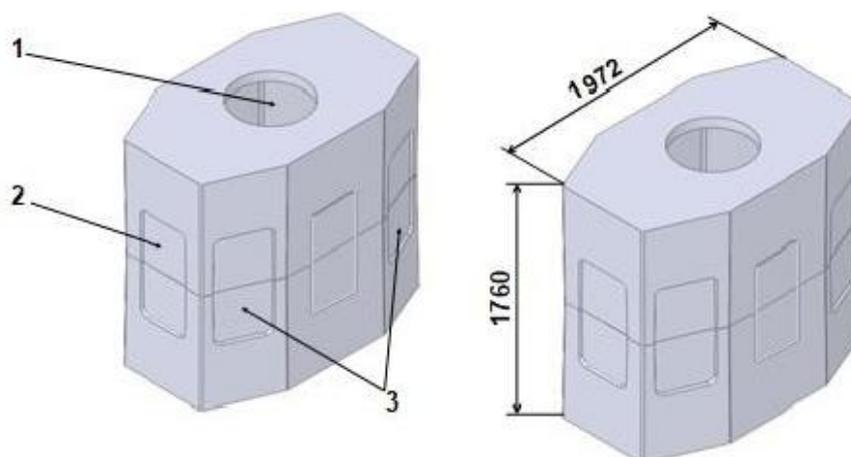
Рис. 3. Детали и габаритные размеры колодца «ККСр-3,5-10(80)» в сборе:
