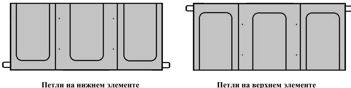
Рис. 8. Вид сбоку на элементы колодца «ККСр-3,5-10(80)». Показаны места выхода подъёмных петель.
