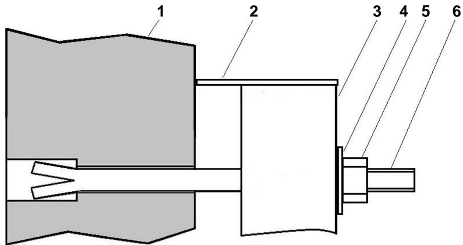
**Рис. 3.3. Крепление кронштейна «ККП-130» на стене колодца «ККСр-3,5-10(80)»:**
