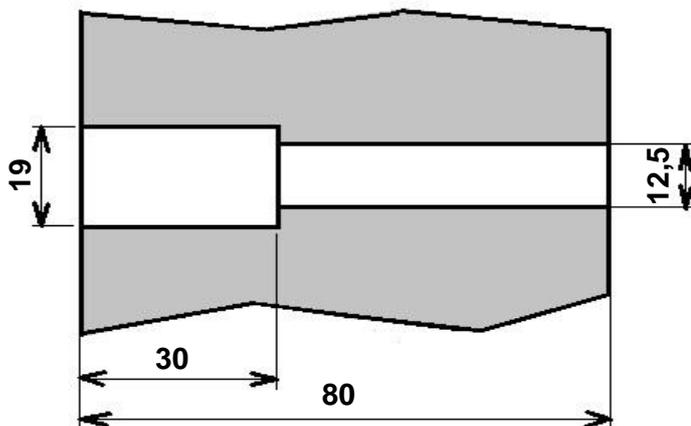
Рис. 3.1. Форма и размеры отверстий для ершей в стенах колодца «ККСр-3,5-10(80)». Слева – наружная сторона стены, справа – внутренняя сторона стены.
