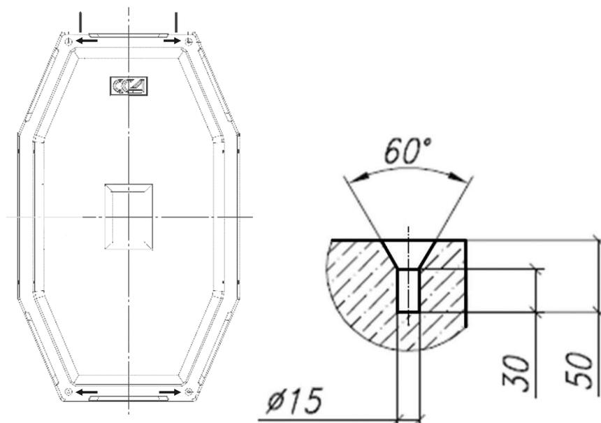
Рис. 11. Углубления для стержней на углах элемента колодца и форма углубления. Углубления показаны стрелками.
