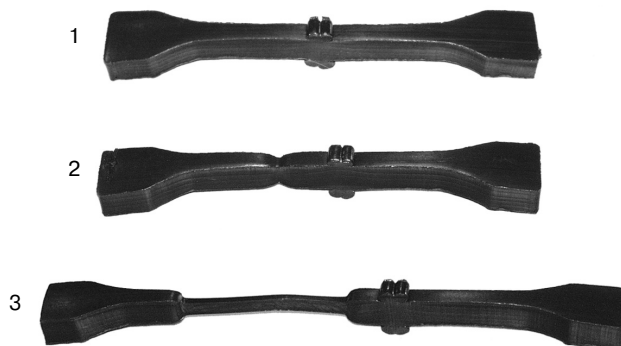
Фото 4.2.9. Образец с фрагментом стыкового сварного соединения (1).
