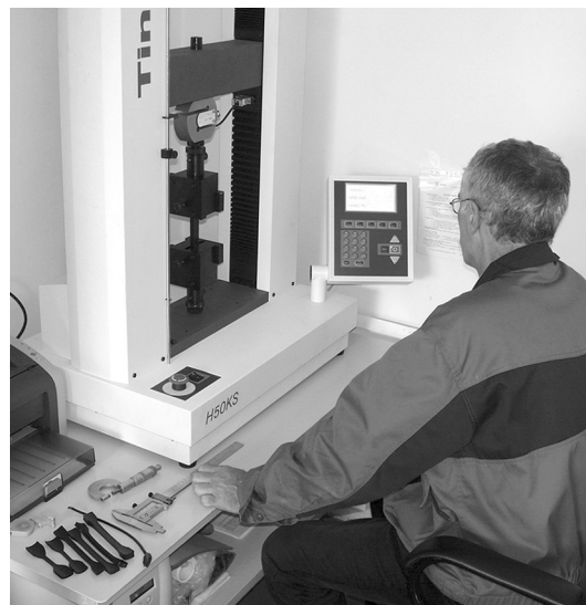
Фото 4.2.8. Испытания стыковых сварных соединений в лаборатории ИКАПЛАСТ
