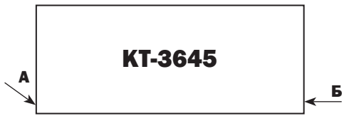
Схема “в”: комбинированный (прямой и угловой) разносторонний ввод
