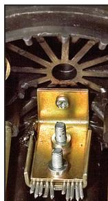
**Примечание** – Если ЦСЭ представляет собой стальной трос с полимерным покрытием, выполнить электрическое соединение ЦСЭ с броней ОК, используя перемычку электрического соединения.
