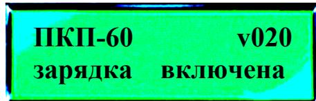
Время полной зарядки аккумуляторов может составлять более 10 часов. Адаптер может быть подключен к прибору постоянно.
