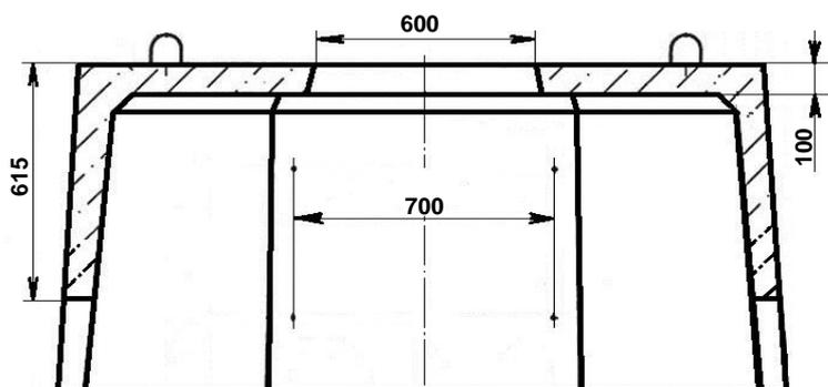
Рис. 8. Размеры колодца «ККСр-3-80» на продольном разрезе верхнего элемента:
