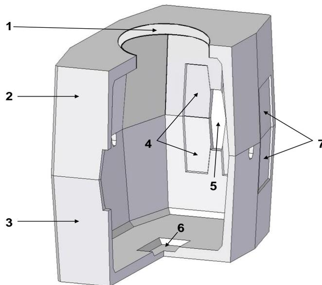
**Рис. 4. Колодец «ККСр-3-80» в сборе, внешний вид и детали элементов колодца:**
