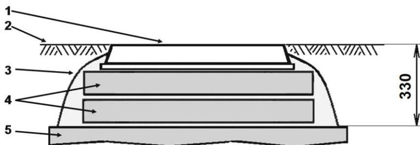
Рис. 13. Расстояние от перекрытия колодца до уровня дорожного покрытия на проезжей части должно быть – не менее 330 мм:
