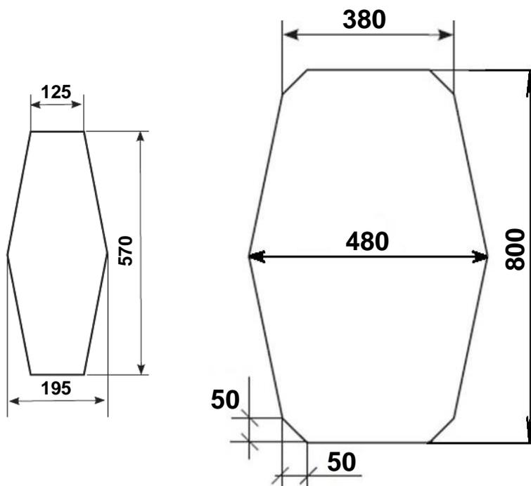
**Рис. 2.2. Размеры технологического отверстия и участка с тонкой
