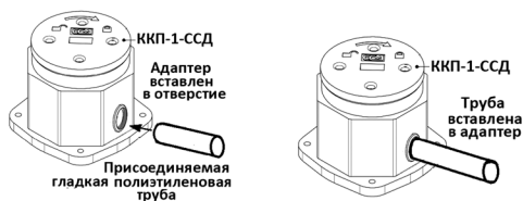
Рисунок 18 – Ввод гладкой трубы в адаптер
